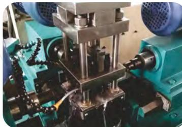
LM Guide - AC Servo - Ball Screw
